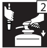
2. Schlauch fassen, Druckhebel kurz niederdrücken und loslassen.
